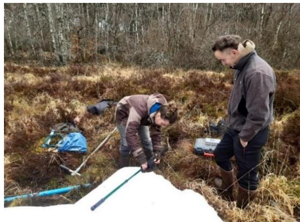
Figure 9 : Pose des piézomètres en octobre 2024
