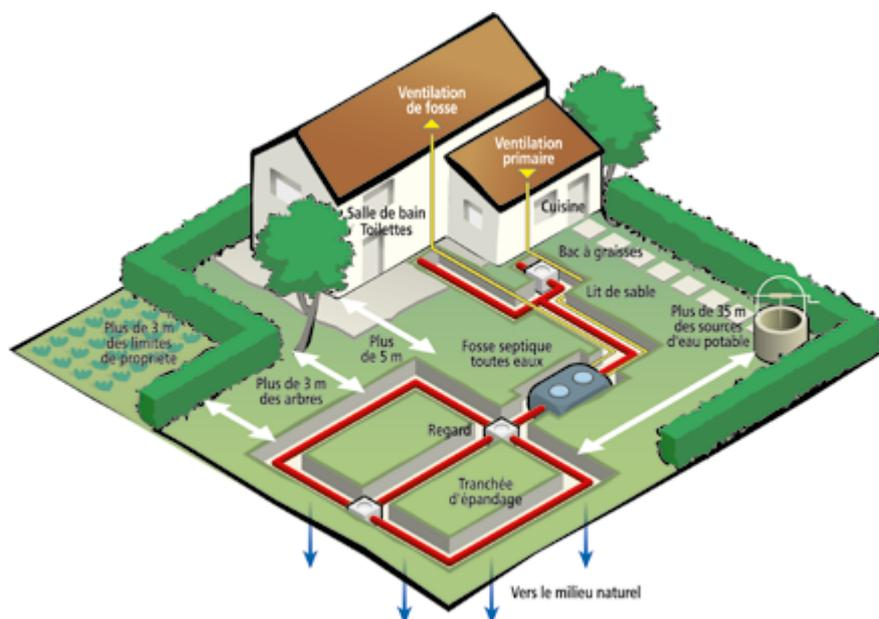
Schéma d'un système d'assainissement non collectif traditionnel.
